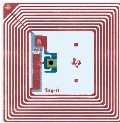
Obr. 1 Vnitřní struktura RFID tagu [5].
