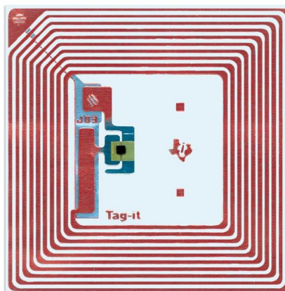
Obr. 1 Vnitřní struktura RFID tagu [5].
