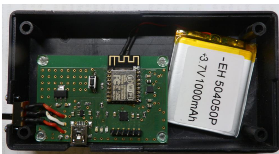
Obr. 34 Výsledné lokalizační zařízení zakomponované v krabičce
