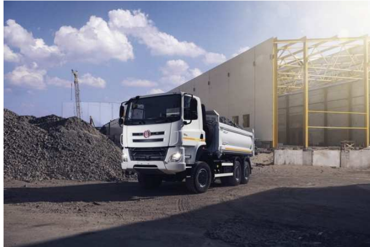
Obr. G.6 TATRA Phoenix 6x6 s třístranným sklápěčem [30]
