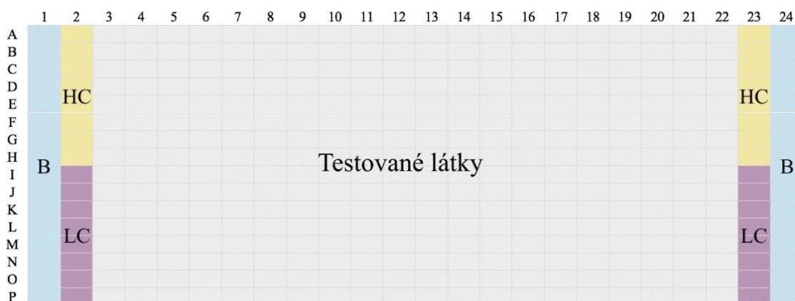
Obr. 9: Schéma rozloženia roztokov v jamkách doštičky pre validáciu fluorescenčnej metódy použitím komerčnej chemickej knižnice Prestwick. B – slepá vzorka (pufer pre CA IX); HC – pozitívna kontrola (50 nM CA IX a 100 nM AZA); LC – negatívna kontrola (50 nM CA IX); jamky A3 – P22 – testované látky z chemickej knižnice Prestwick a 50 nM roztok CA IX.
