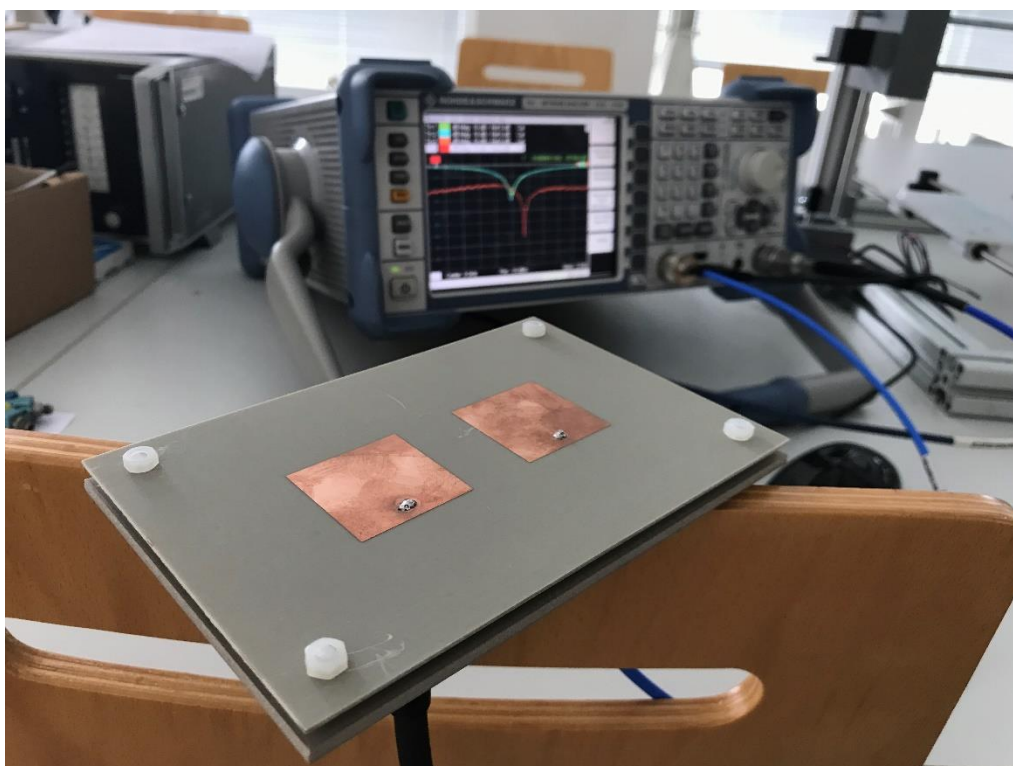
Anténa v rovině H při měření S-parametrů
