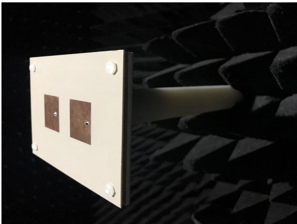
Anténa v rovině E v bez-odrazové komoře.
