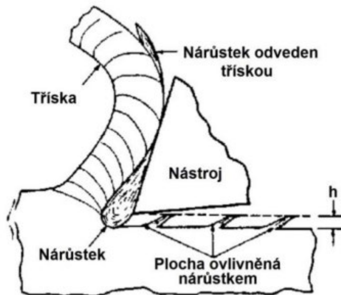
Obr. 25 Ovlivnění povrchu při tvorbě nárůstků [23].
