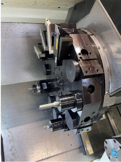
Obr. 29 Revolverová hlava pro 12 nástrojů.
