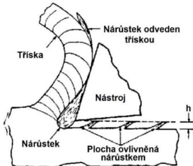
Obr. 25 Ovlivnění povrchu při tvorbě nárůstků [23].
