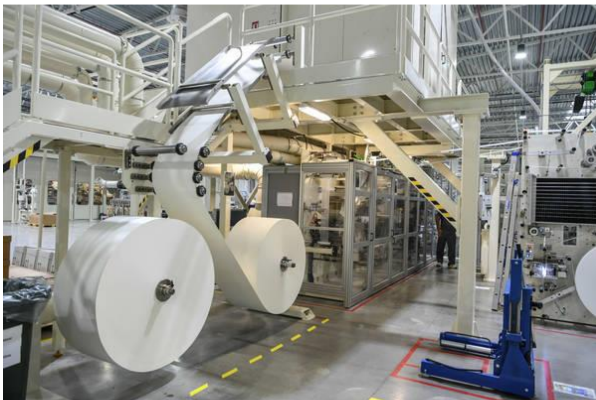
Obr. 3.2 Odvíjení netkaného materiálu na odvíjecím zařízení.
