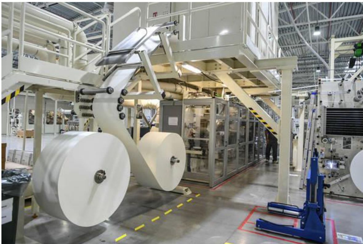
Obr. 3.2 Odvíjení netkaného materiálu na odvíjecím zařízení.
