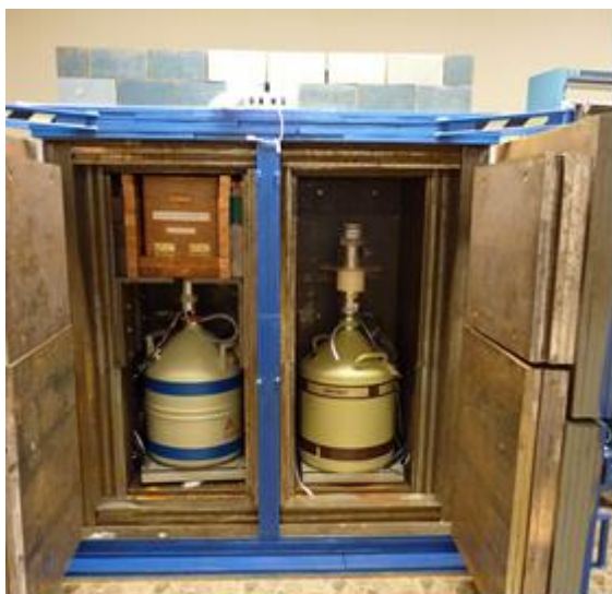
Obr. č. 10: HPGe detektory ve stínění z olova Zdroj: (Záhorová, 2021)
