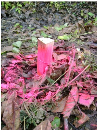
Obr. 25: Označení pomocných měřických bodů
