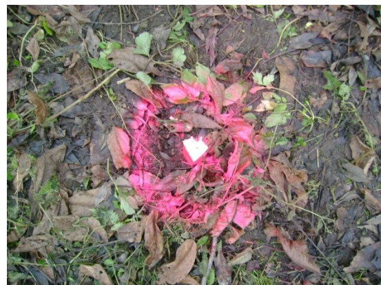
Obr. 26: Označení pomocných měřických bodů
