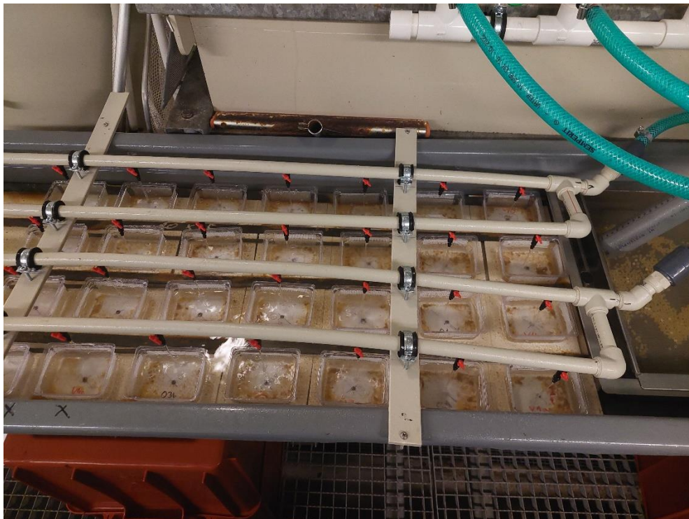
Obr. 5 Inkubační aparáty spojené do celého systému (foto: Beránek)
