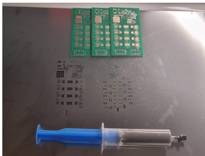
Obrázok 14 - Spájkovacia pasta a šablóna pre jej aplikáciu
