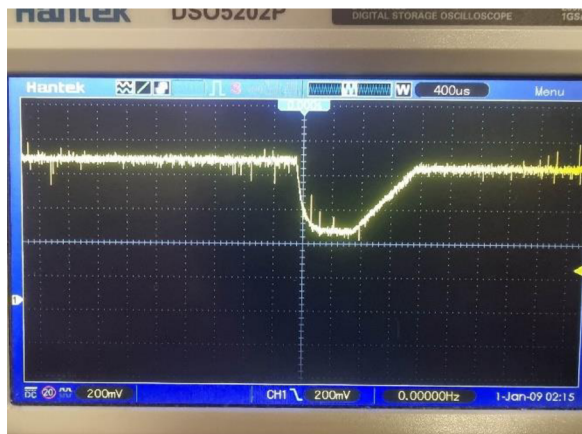
Obrázok 24 – Tranzitná odozva zapojenia pri záťaži 5m \Omega , \Delta I = 180A
