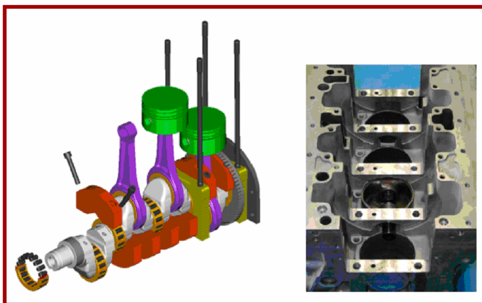
Obr. 5.4.3 Montáž klikového mechanismu a snímek bloku motoru [20]
