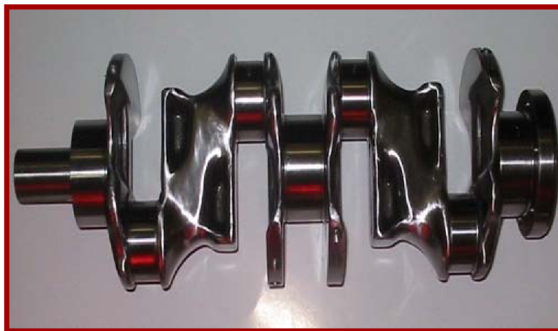
Obr. 3.3.2c Na zakázku upravená kliková hřídel [11]
