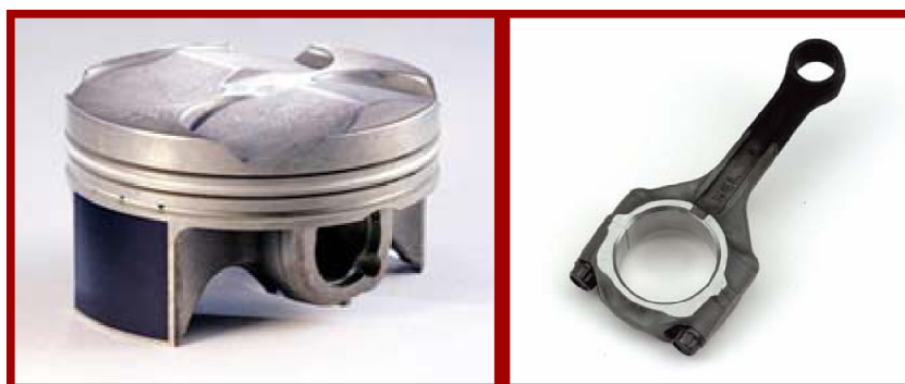
Obr. 5.1.2 Ultralehký píst a ojnice [16]
