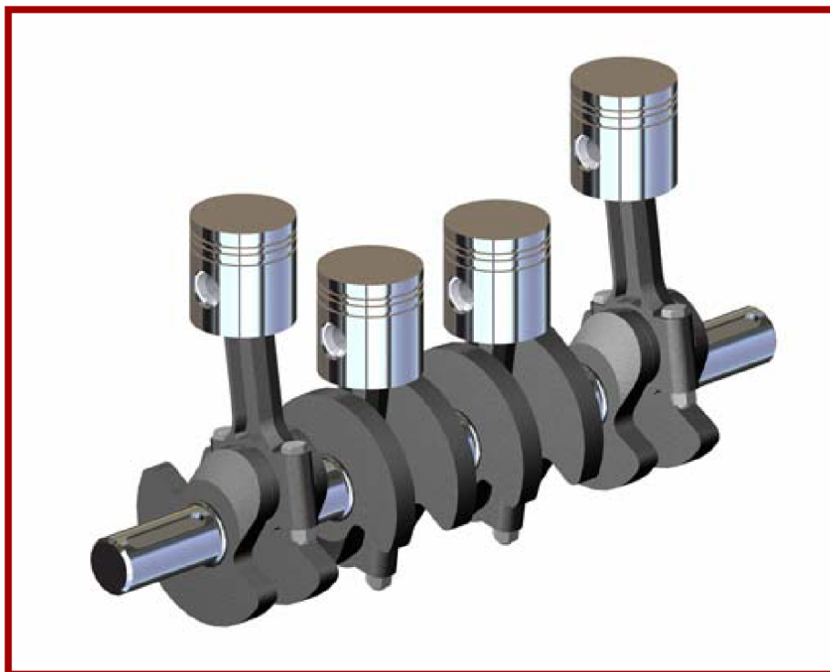
Obr. 1 Běžné konstrukční uspořádání klikového mechanismu současné doby pro motor se čtyřmi válci v řadě [3]
