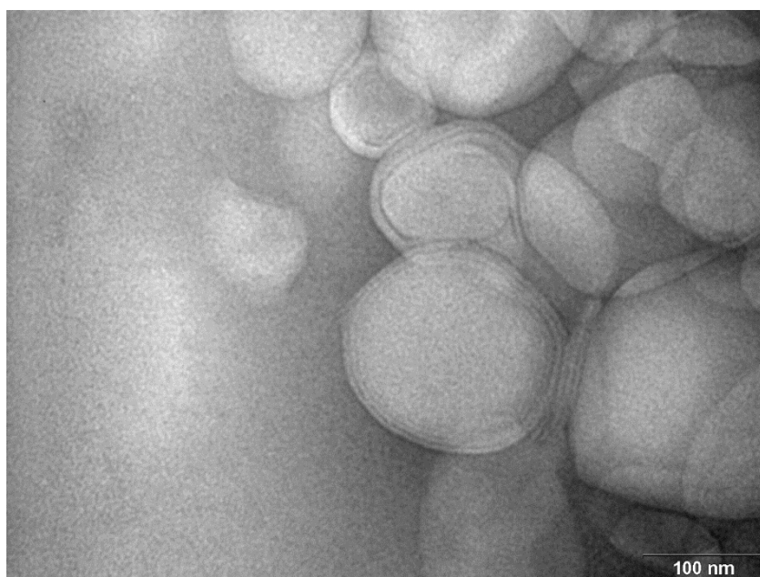
Obrázek 36 : Snímek liposomů získaných pomocí hydratace lipidového filmu, před extruzí, TEM (Philips EM 208) VÚVeL, laboratoř Elektronové mikroskopie
