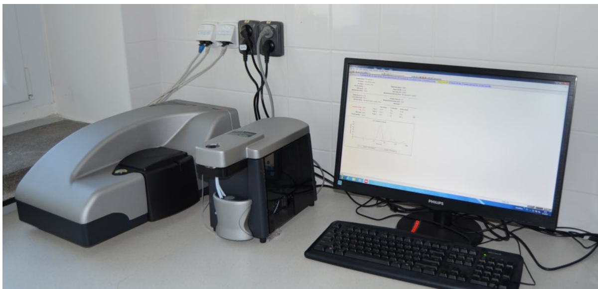
Obrázek 19: Zetasizer Nano ZSP, of firmy Malvern (Laboratoř NanoPharm, VÚVeL, Brno)
