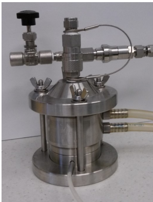
Obrázek 13: Extrudér Lipex 10 (Laboratoř NanoPharm, VÚVeL, Brno)
