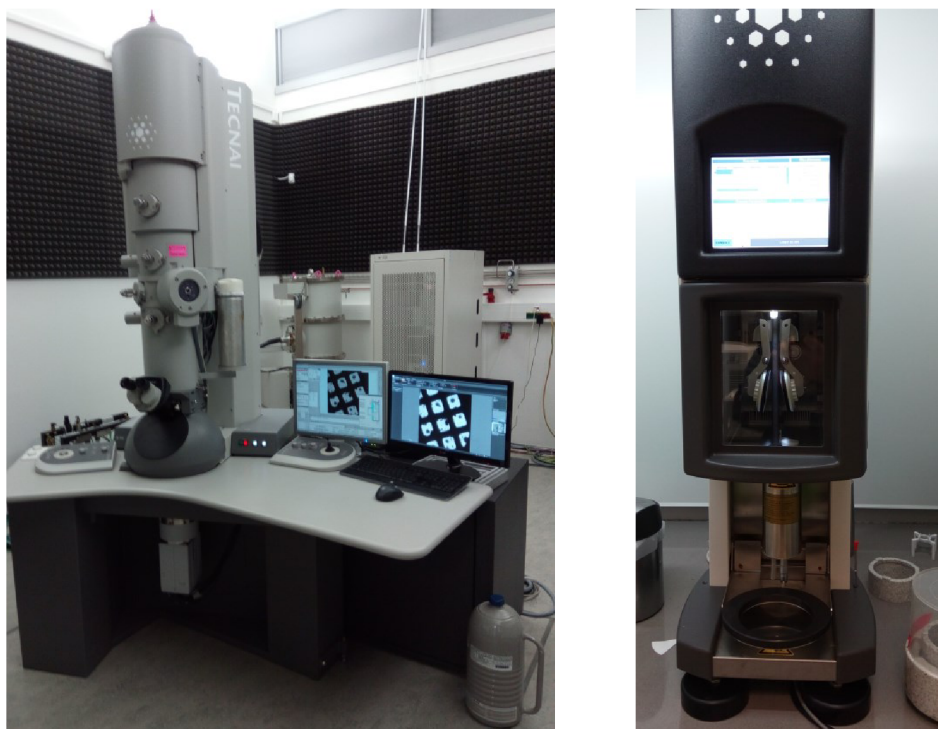
Obrázek 28: Mikroskop TEM FEI Tecnai F20 (vlevo), Vitrobot (vpravo) (Laboratoř elektronové mikroskopie CEITEC)
