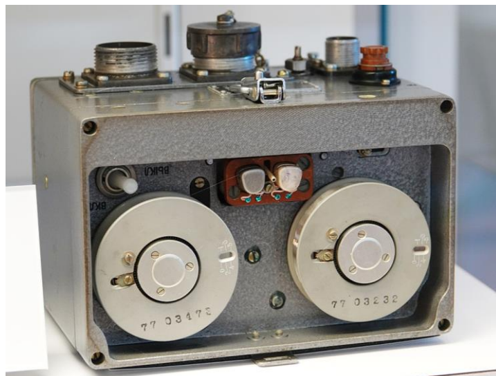
Obr. 2.2 Hlasový záznamník v kokpitu letounu MiG-21 [5]
