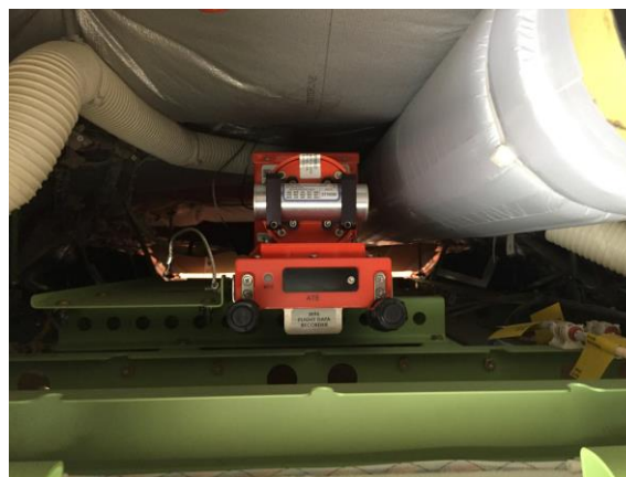
Obr. 2.8 Zástavba FDR do letadla Boeing 737 [19]
