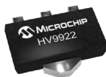
Obrázek 4.4: Integrovaný obvod Microchip HV9922 [14]
