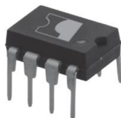
Obrázek 4.6: Integrovaný obvod Power Integrations LYT0006P [15]
