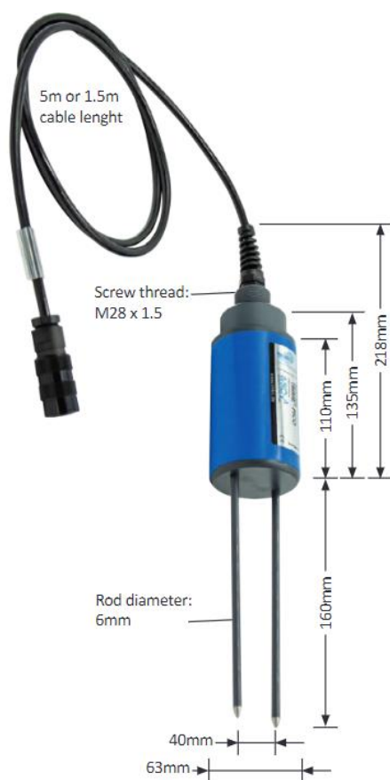
Obrázek 7: Popis rozměrů senzoru PICO 64 (IMKO, ©2023a).
