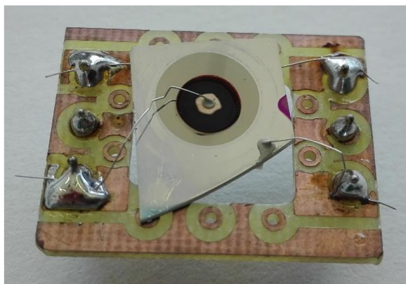
Obr. 5.17: Senzor s připájenými drátky.
