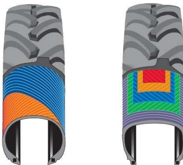
Obr. 2 - Konstrukce pneumatik (diagonální, radiální), (upraveno http://www.mdline.cz/ )
