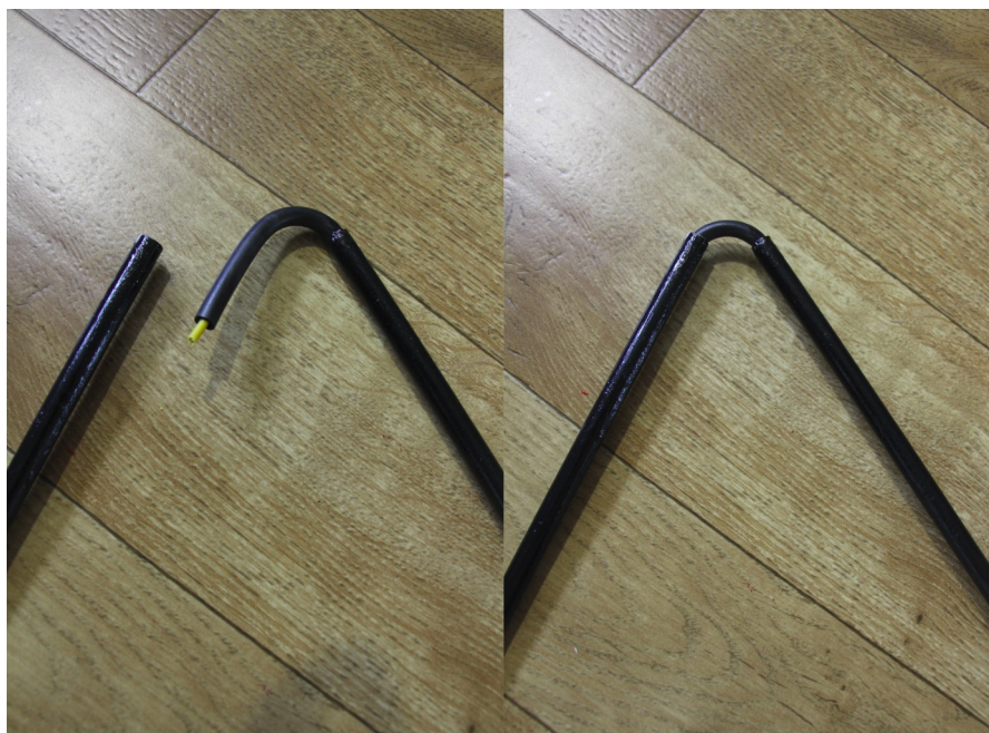
Obr. 24: Detail rozebiratelného kloubu
