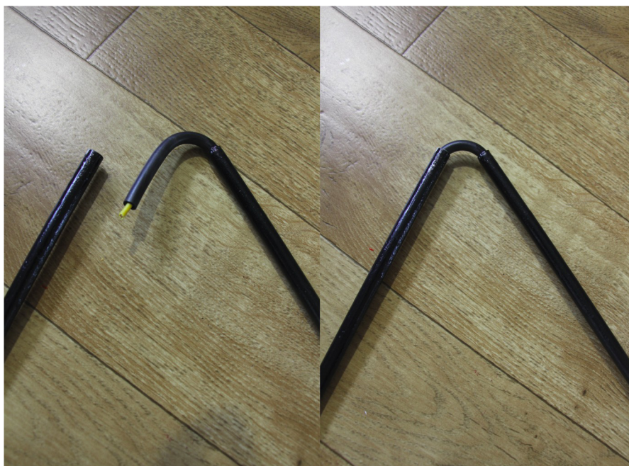
Obr. 24: Detail rozebiratelného kloubu
