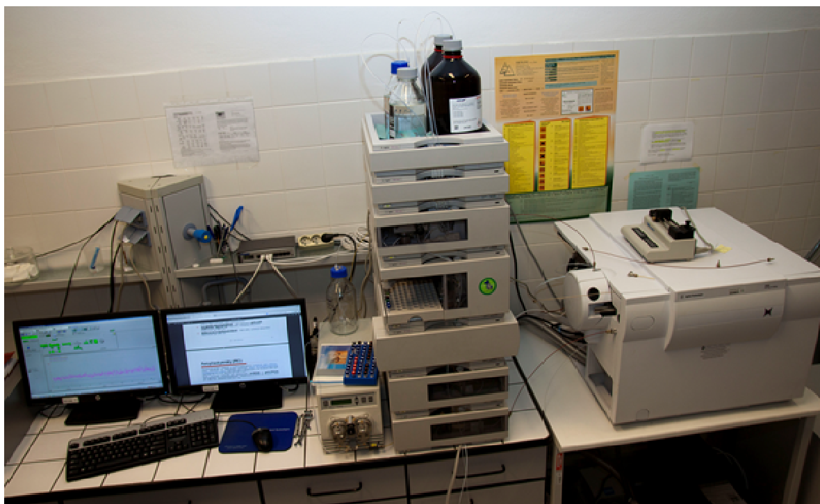
Obrázek 21 – HPLC Agilent 1100 Series s DAD detektorem a hmotnostní spektrometr Agilent 6320 Series
