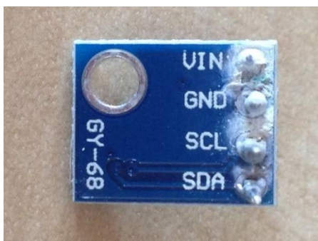
Obrázek 31: Zkorodovaný senzor č. 4
