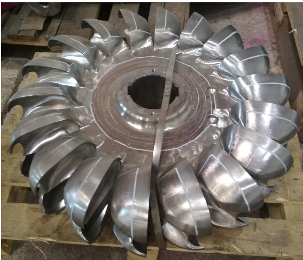
Obr. 1.8 Obežné kolo Peltonovej turbíny
