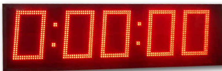
Obr. 16: Zobrazovač s vysoce svítivých LED
