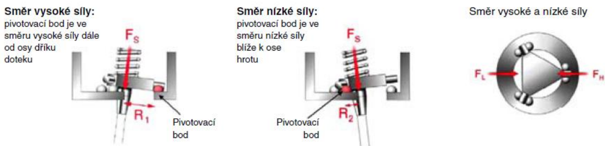
Obrázek 3 – Naklápění mechanismus při působení kontaktních sil
