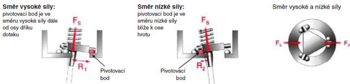
Obrázek 3 – Naklápění mechanismus při působení kontaktních sil
