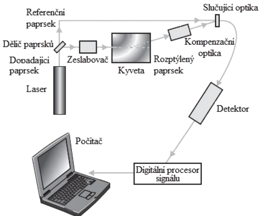
Obr. 16 Schéma zařízení pro měření zeta potenciálu [57]
