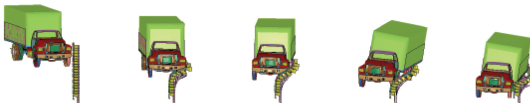
Obr. 7.14 Deformace svodidla během testu TB42 – experiment a simulace [10]
