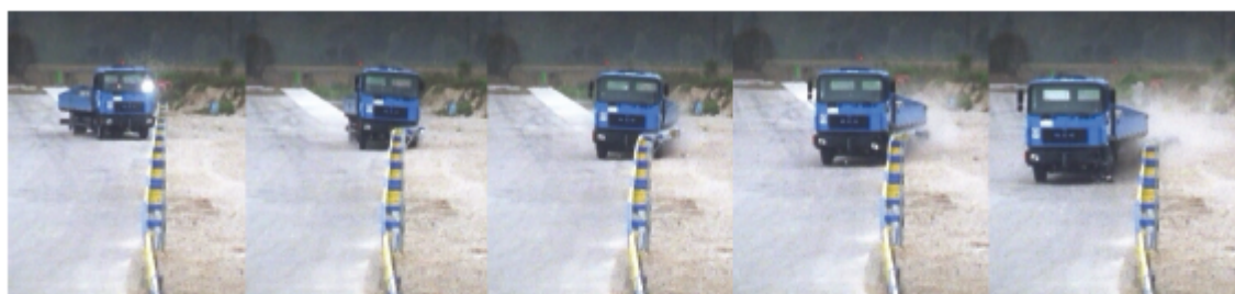
Obr. 7.13 Deformace svodidla - srovnání simulace a skutečného experimentu [10]
