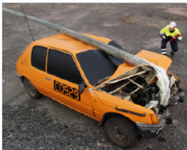
Obr. 7.9 Zdeformovaný sloup a vozidlo po nárazu ve 100 km/h [13]
