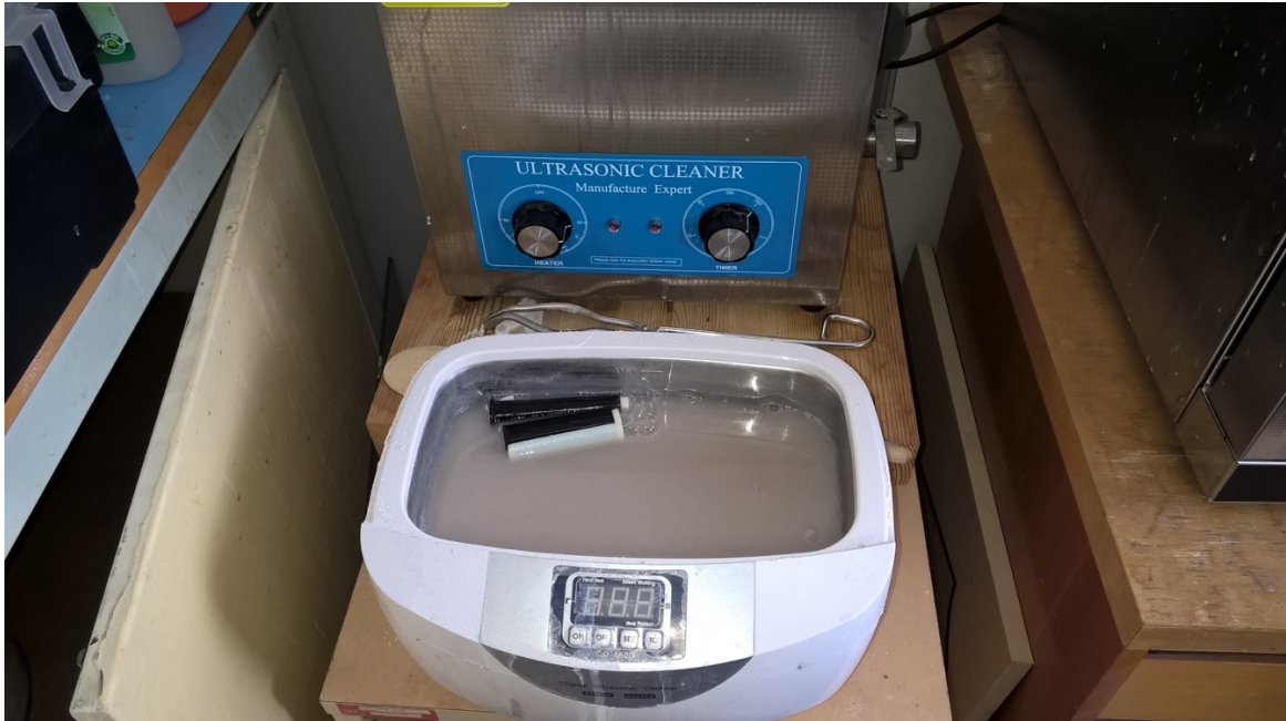
Obr. 3.25: Vyplavenie podporného materiálu pomocou ultrazvukovej čističky a špeciálneho roztoku. 75
