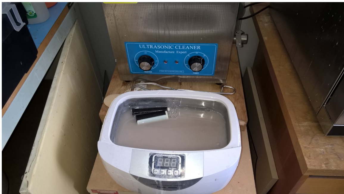
Obr. 3.25: Vyplavenie podporného materiálu pomocou ultrazvukovej čističky a špeciálneho roztoku. 75
