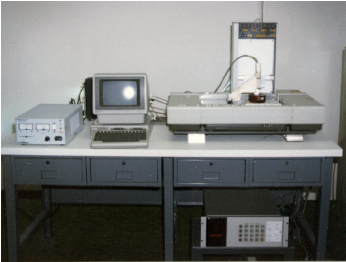
Obr. 2.1: Prvá 3d tlačiareň SLA-1. 6
