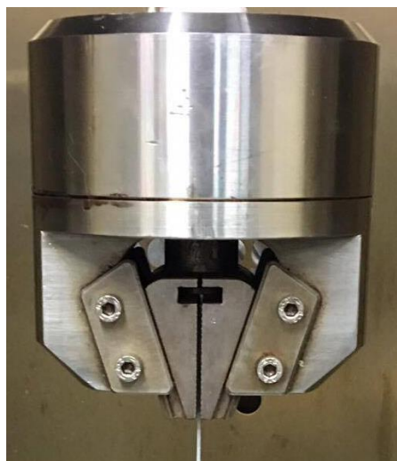
Obr. 3.3: Detail čelisti s upnutým vzorkem
