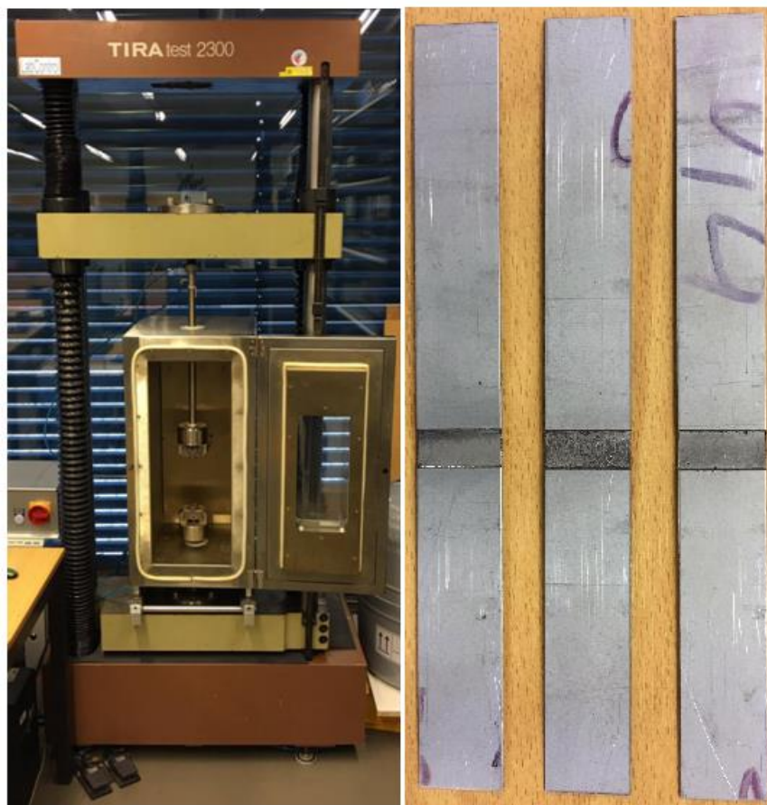
Obr. 3.1: TIRA test 2300 (vlevo) a vzorky použité při experimentu
