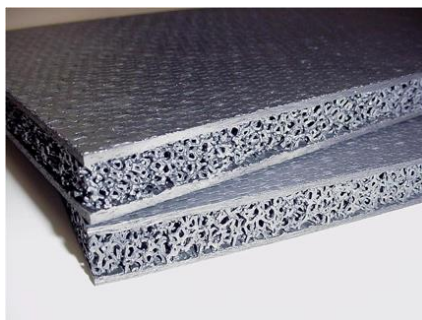
Obr. 2.5: Vrstvený materiál s vnější vrstvou z vláknom vyztuženého kompozitu [12]
