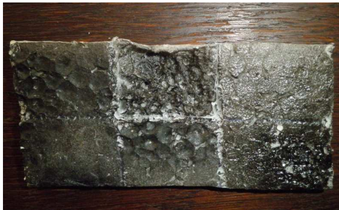
Obr. 4.7 Polystyrénový vzorek s různým procentním zastoupením lepidla Herkules po nanesení černého spreje PRIMA.
