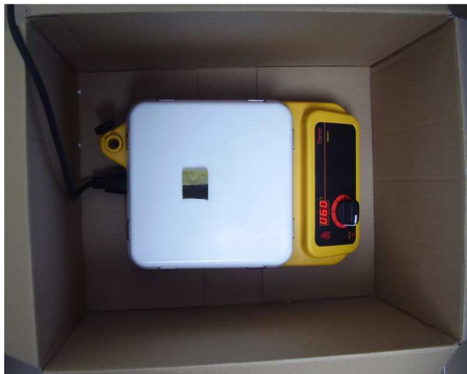
Obr. 4.19 Poloha vzorku skelné vlny s podélným charakterem vláken.
