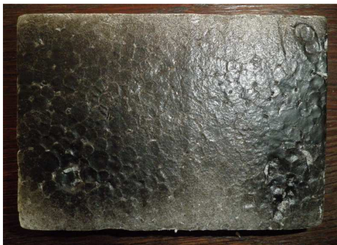
Obr. 4.5 Polystyrénový vzorek po nanesení černého spreje PRIMA s ochrannou vrstvou v horizontálním a vertikálním směru (Styro RC).
