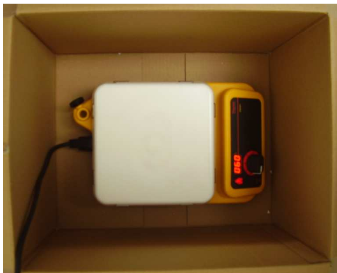
Obr. 4.1 Umístění plotýnky v ochranné krabici.
