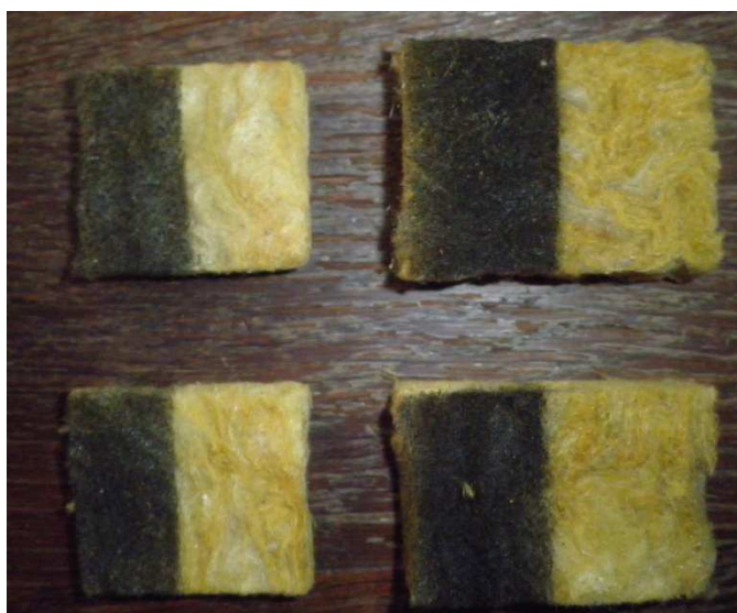
Obr. 4.10 Umístění spreje s emisivitou 0,96 na vzorcích skelné vlny.
