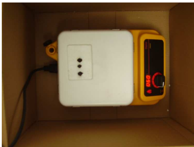
Obr. 4.12 Poloha polystyrénového vzorku na plotýnce.
