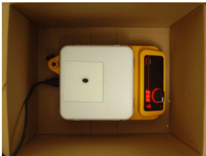
Obr. 4.16 Poloha keramického vzorku na plotýnce.
