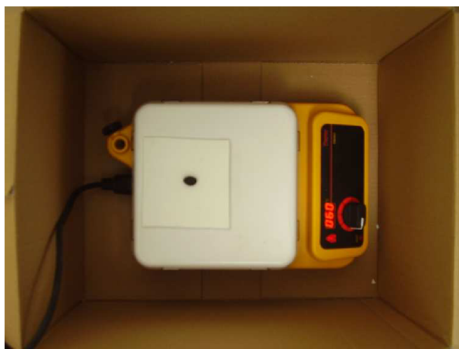
Obr. 4.16 Poloha keramického vzorku na plotýnce.
