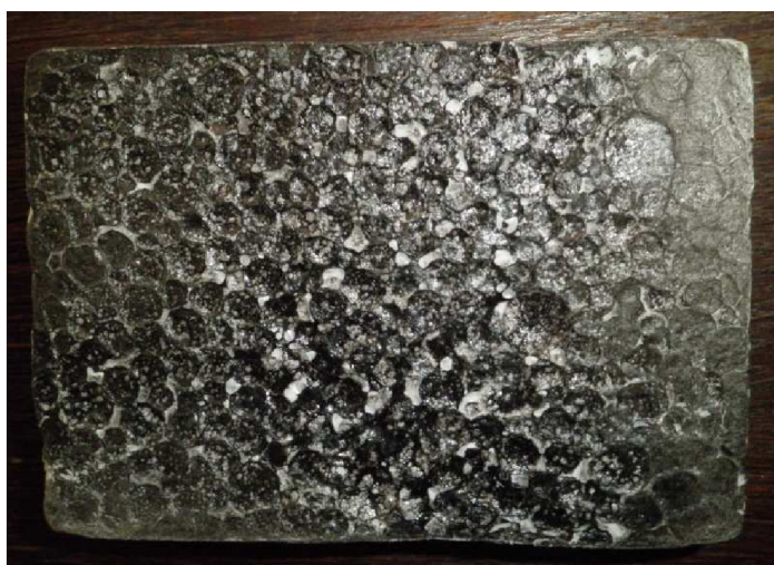
Obr. 4.4 Polystyrénový vzorek po nanesení černého spreje PRIMA s ochrannou vrstvou v horizontálním směru (Styro RC).
