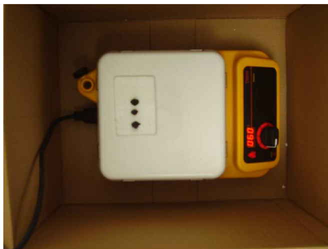
Obr. 4.12 Poloha polystyrénového vzorku na plotýnce.
