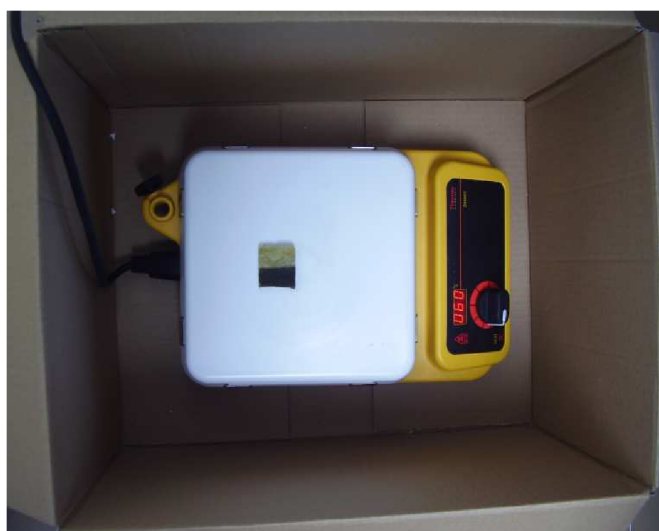
Obr. 4.18 Poloha vzorku skelné vlny s příčným charakterem vláken.
