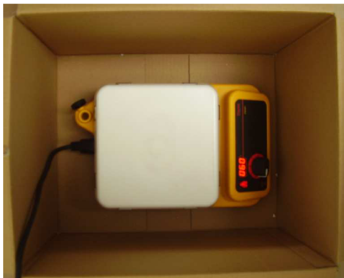
Obr. 4.1 Umístění plotýnky v ochranné krabici.
