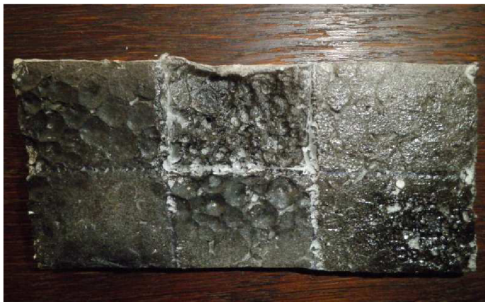
Obr. 4.7 Polystyrénový vzorek s různým procentním zastoupením lepidla Herkules po nanesení černého spreje PRIMA.
