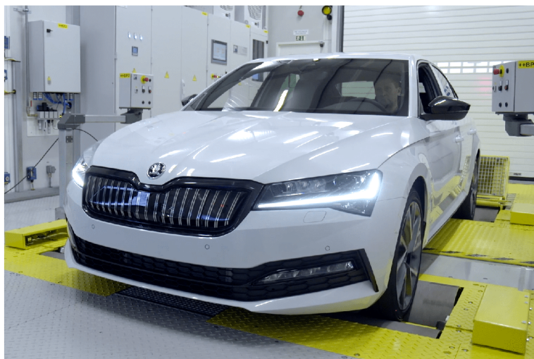
Obrázek 4.1: Válcový dynamometr v řízení kvality v závodu Kvasiny [14]
