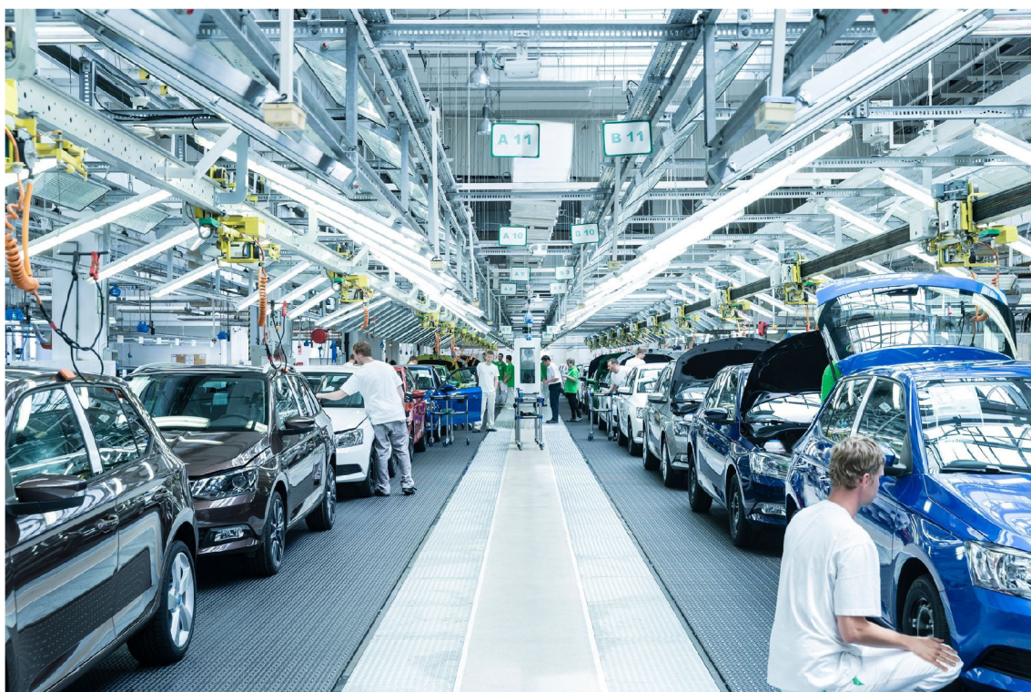
Obrázek 4.2: Lícování a nabíjení baterie zavěšenou externí nabíječkou (žlutá s oranžovým kabelem) po stanovišti B18 [15]
