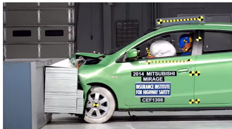
Obr. 7: Náraz vozu při cash testu. [14]
