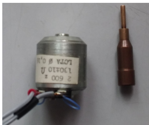
Obr. 19: Detailní záběr na elektromagnet s kotvou.
