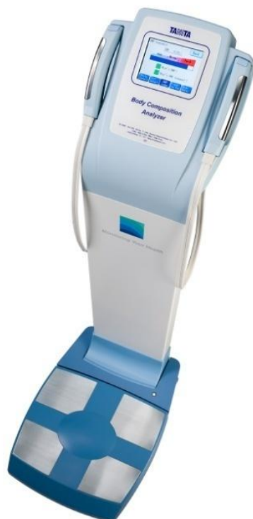
Obrázek 15. Ukázka přístroje Tanita MC 180 MA (upraveno dle www.tanita.com )
