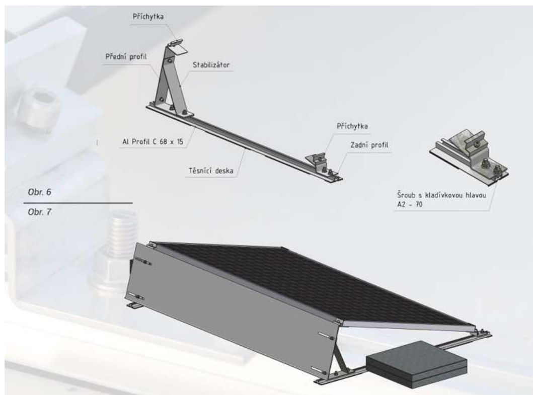
Obrázek 34: Nosná konstrukce pro FVE panel [18]
