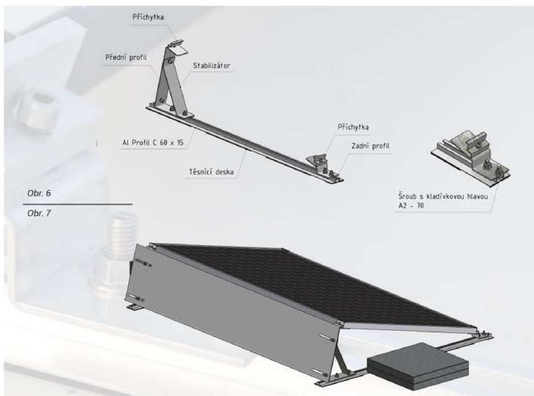
Obrázek 34: Nosná konstrukce pro FVE panel [18]
