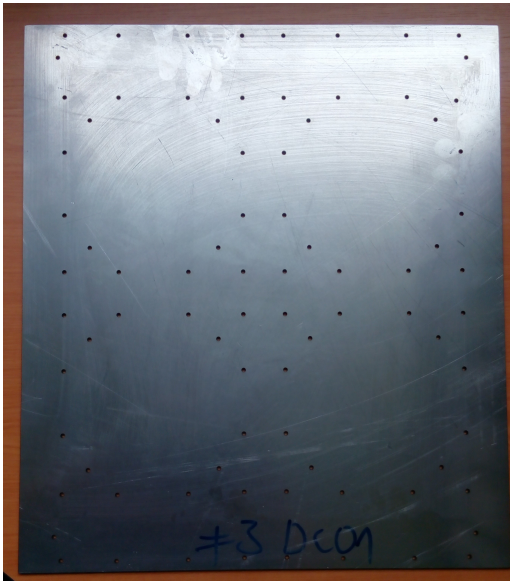
Obr. 11.8: Navrtaný plech tloušťky 3 mm
