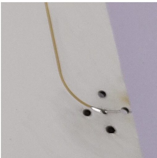
Obr. 11.5: Střední vodič konektoru připájený ke stripline vedení
