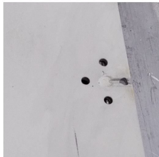
Obr. 11.6: Zahloubení do spodního substrátu
