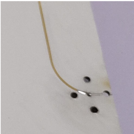
Obr. 11.5: Střední vodič konektoru připájený ke stripline vedení
