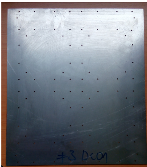
Obr. 11.8: Navrtaný plech tloušťky 3 mm
