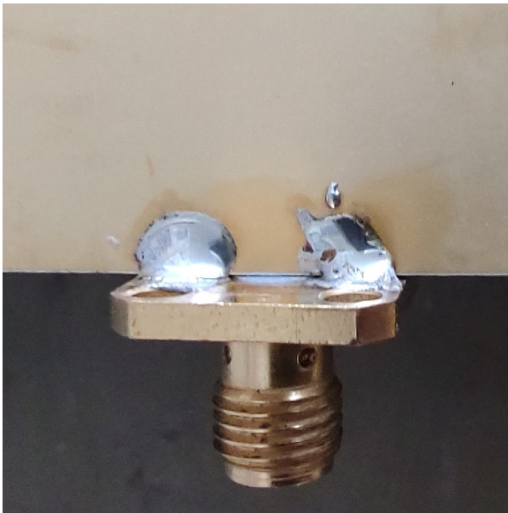
Obr. 11.1: Původní konektor (připájen na zemní plochu)
