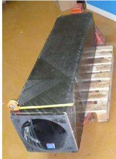
Obr. 5.5. Celokompozitové smykadlo pro výzkumné centrum VCSVTT. [9]
