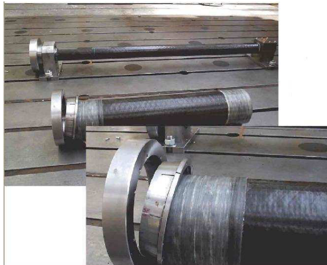
Obr. 4.3. Kompozitové hřídele používané společností Tajmac-ZPS, a.s. u vícevřetenových automatů. [4]
