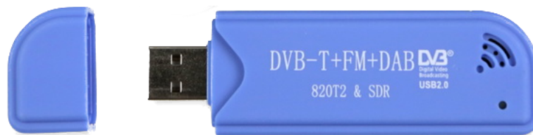
Obr. 4.2: Zařízení RTL-SDR pro zachycení radiového signálu.
