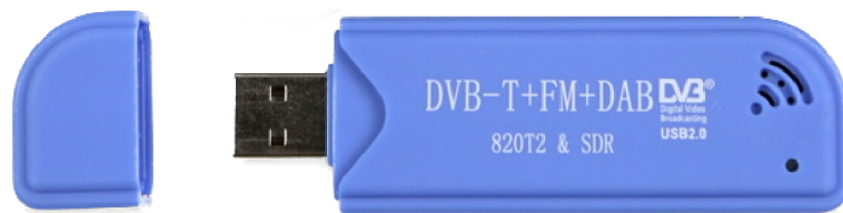
Obr. 4.2: Zařízení RTL-SDR pro zachycení radiového signálu.
