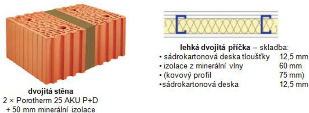
Obrázek č. 37: Možnosti skladby akustických stěn ([22] str. 40, [47] str. 18)
