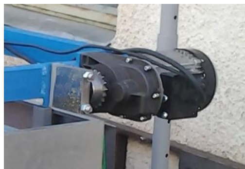
Obr.4-20. Upravený elektrický naviják s řetěz. kolem
