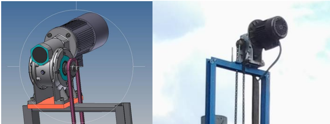
Obr.4-23. Uložení vrátku v horní části věže
