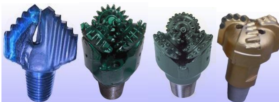
Obr. 3-3. Typy používaných vrtných korunek [10] (listové dláto, valivé dláto, roubíkové dláto, diamantové dláto typ SO)
