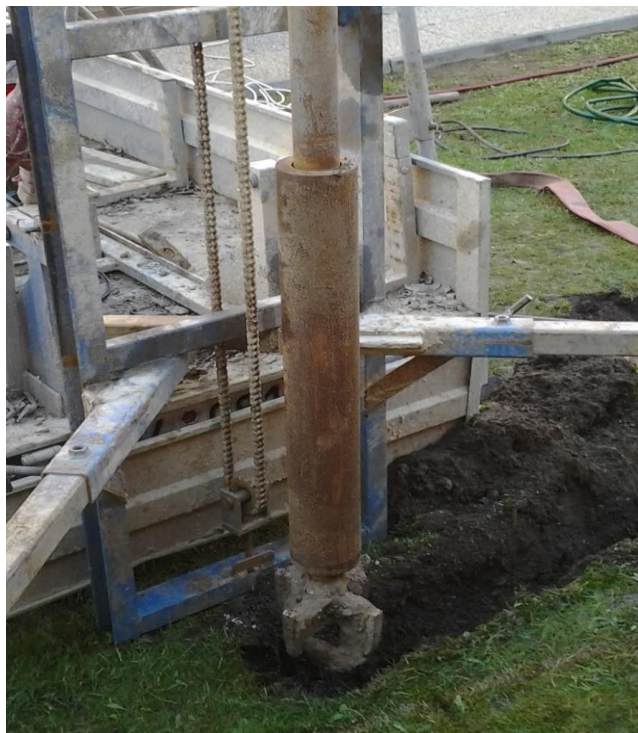
Obr.6-5. Zátěžka umístěná za vrtací korunkou
