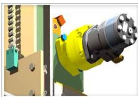
Obr. 2-12. Vrátek s hydraulickým pohonem a automatickou brzdou [6]
