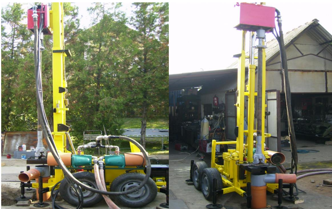
Obr. 2-6. Malá hydraulická vrtná souprava maďarského výrobce [3]
