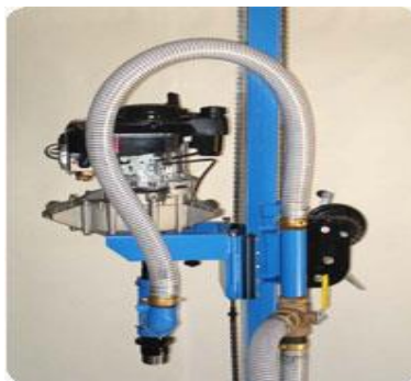
Obr. 2-14. Kluzné uložení vrtné jednotky ve věži [7]
