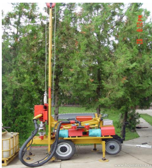
Obr. 2-5. Malá elektrická vrtná souprava maďarského výrobce[2]
