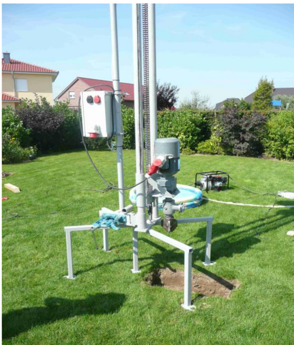
Obr. 2-7. Přenosná vrtná souprava Bogatech [4]
