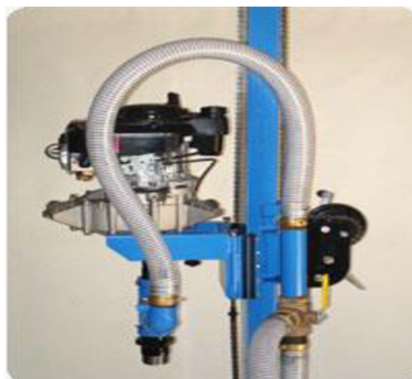
Obr. 2-14. Kluzné uložení vrtné jednotky ve věži [7]
