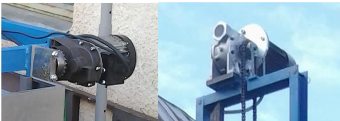
Obr.6-1. Původní a nové řešení konstrukce vrátka
