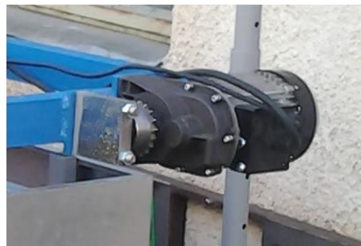
Obr.4-20. Upravený elektrický naviják s řetěz. kolem
