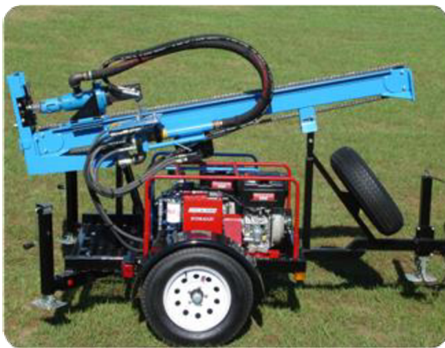
Obr. 2-15. Vrtná souprava LS T1- výrobce LONE STAR DRILLS [8]
