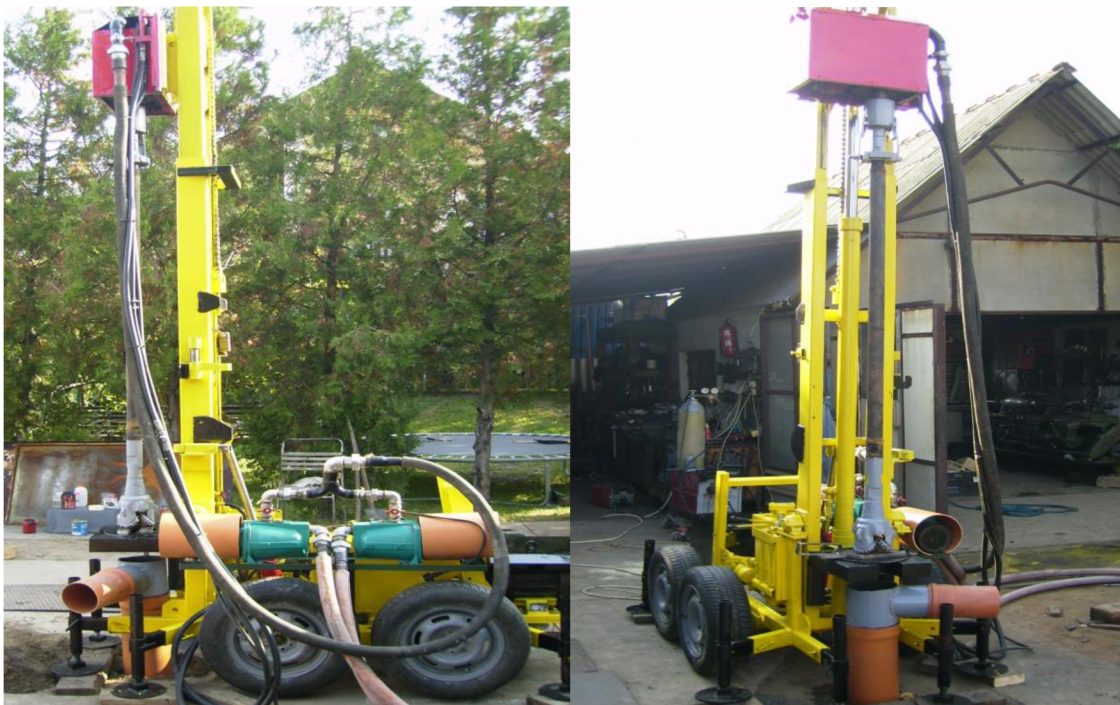
Obr. 2-6. Malá hydraulická vrtná souprava maďarského výrobce [3]
