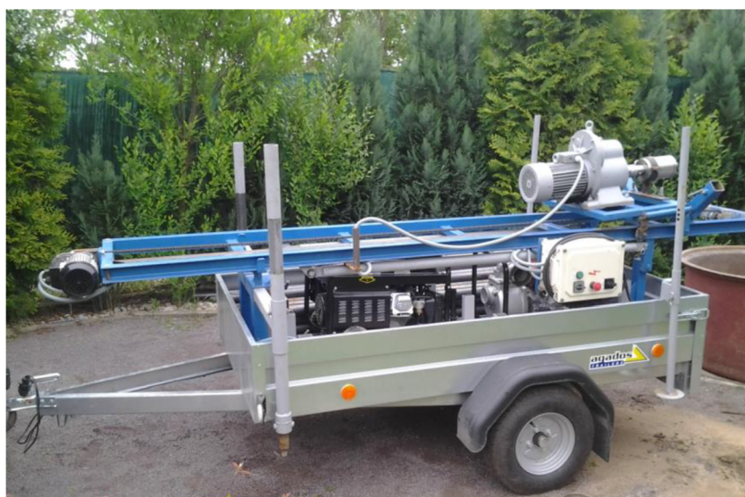
Obr. 4-3. Vrtná souprava v přepravní poloze
