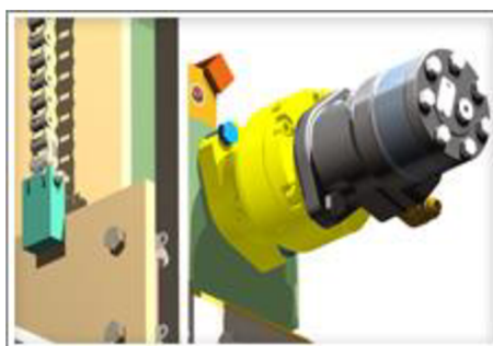
Obr. 2-12. Vrátek s hydraulickým pohonem a automatickou brzdou [6]
