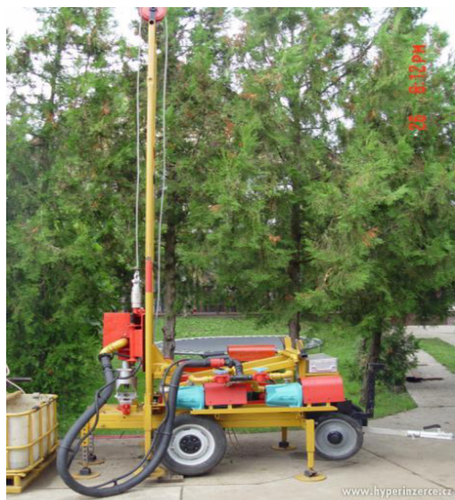
Obr. 2-5. Malá elektrická vrtná souprava maďarského výrobce[2]
