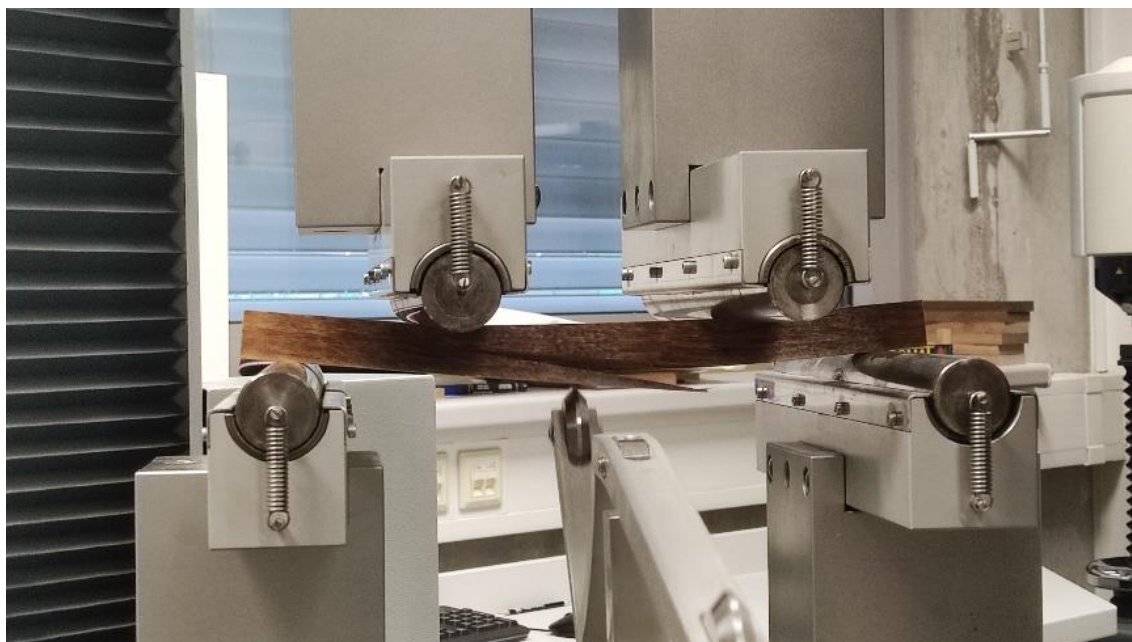
Obr. 6 Zkouška čtyřbodovým ohybem
