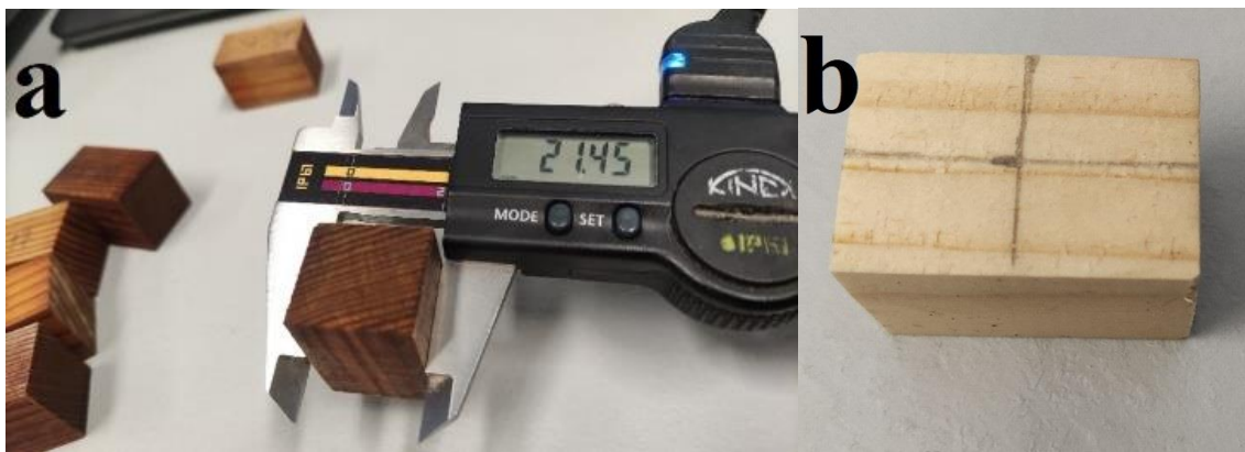
Obr. 7 Měření rozměrů při zkoušce nasákavosti (a) a označení plochy vzorků (b).
